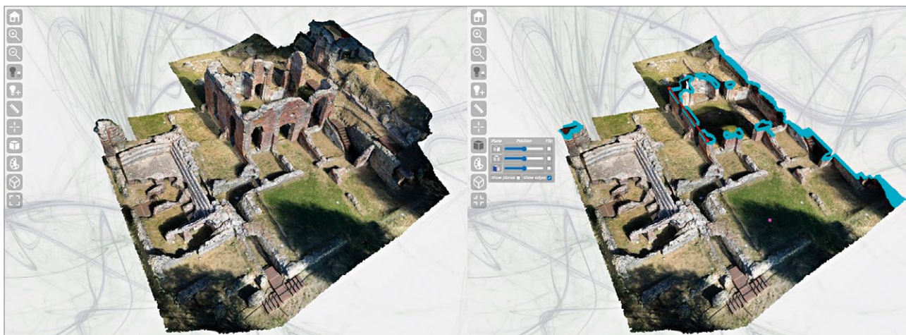
fig. 3 – Il modello 3D visualizzato con 3DHOP. A destra dell'immagine alcune opzioni sviluppate dal software: coordinate (viola), il calcolo delle distanze (rosso), sezioni (azzurro) (© MAPPALAB-UniPI).
