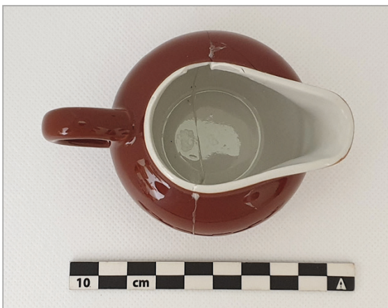
fig. 5. Vista zenitale di ID1. È visibile la linea di frattura centrale e la sbeccatura sull'orlo. Piccoli residui collosi danno conto dell'intervento artigianale del proprietario per riassemble l'oggetto.
