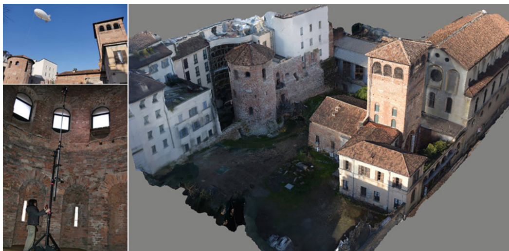
Fig.4 A sinistra: le fasi di lavoro; in alto riprese aeree col dirigibile ad elio, in basso l'asta telescopica. A destra: modello 3D delle strutture archeologiche visibili nell'area museale.
